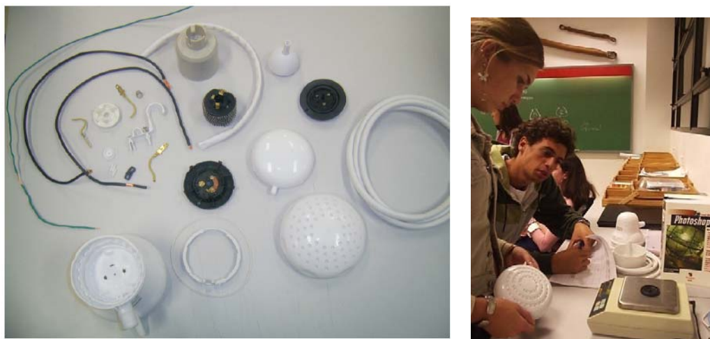
Figura 08 e 09: Chuveiro elétrico desmontado e pesagem dos componentes com uso de balança de precisão
